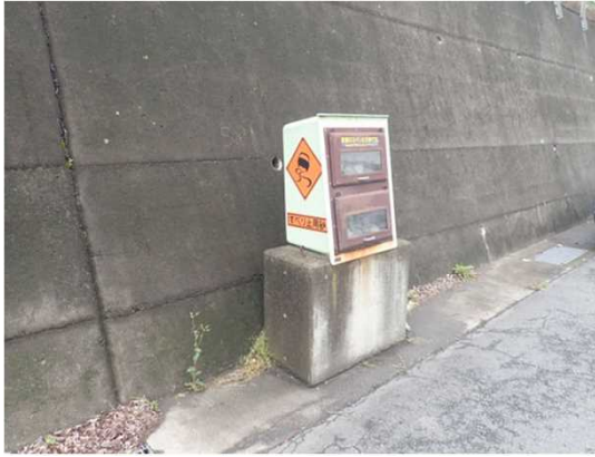
砂箱の設置事例①(群馬県内:国道17号)
