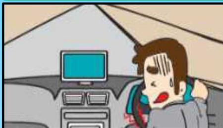
ドライバーが安全に運転出来ない状態に陥った場合に、ドライバー又は乗客等によるボタンの押下や、システムによる自動検知により車両は自動的に停止します。
